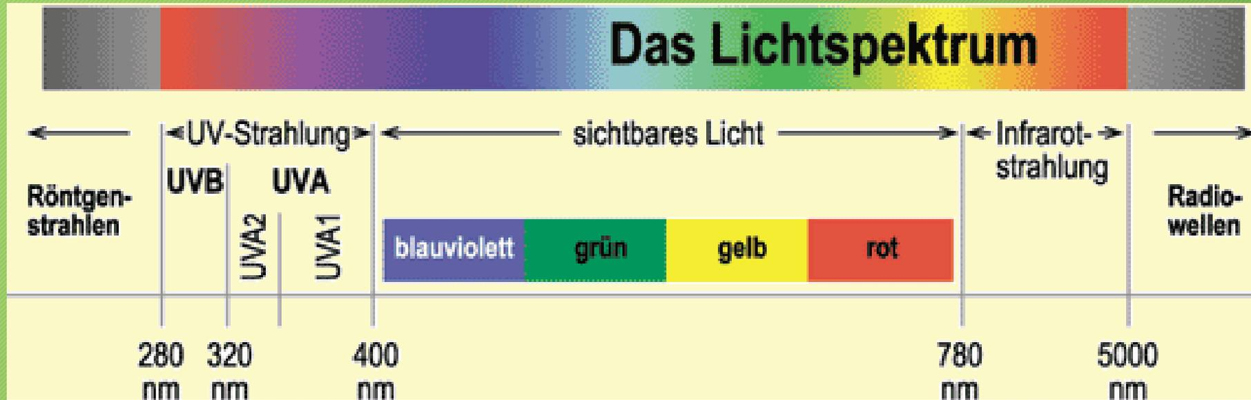
Jede **Farbe** entspricht einer bestimmten **Wellenlänge**. Vom **kurzwelligem Blau** (< 450 nm) über **Grün** und **Gelb** bis zum **langwelligem Rot** (> 600 nm) weist das Spektrum des Sonnenlichts eine fließenden Übergang auf. Die Mischung aller Farben ergibt **weißes Licht**.
